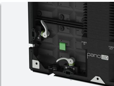
Integrierte Verbinder für eine schnelle Montage
