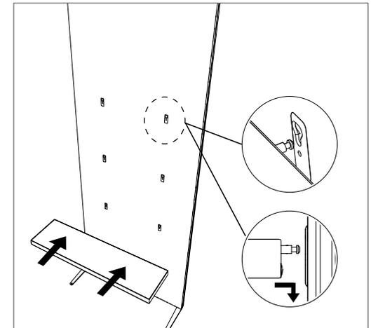
Fijación fácil gracias a la pieza universal de conexión de los accesorios
