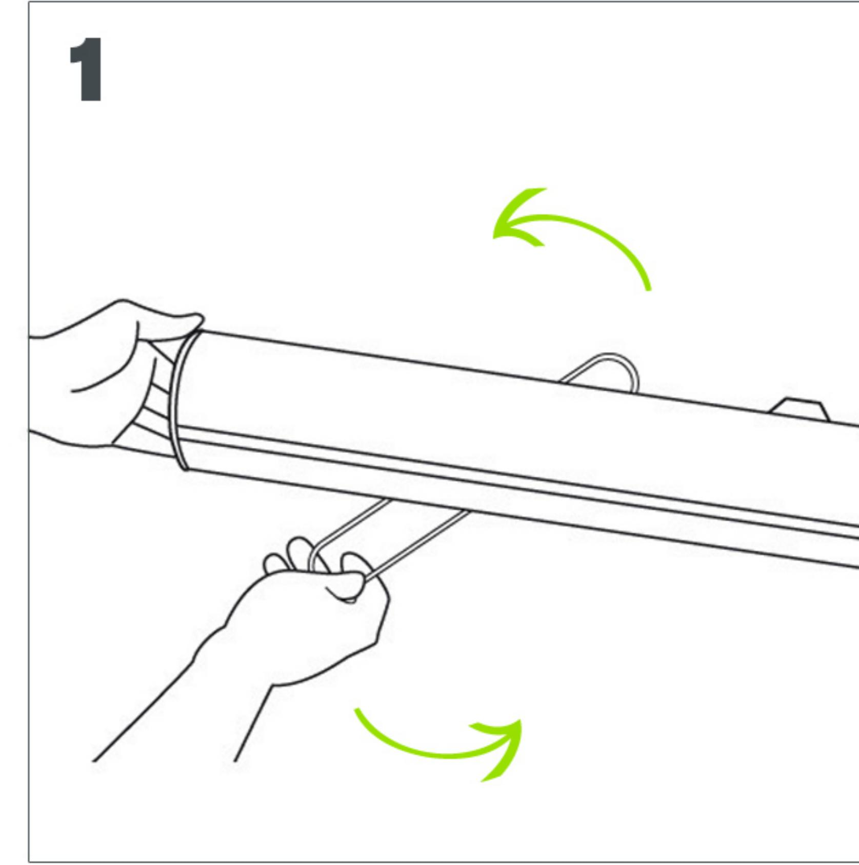
Faites pivoter les pieds escamotables perpendiculairement à l'enrouleur.
