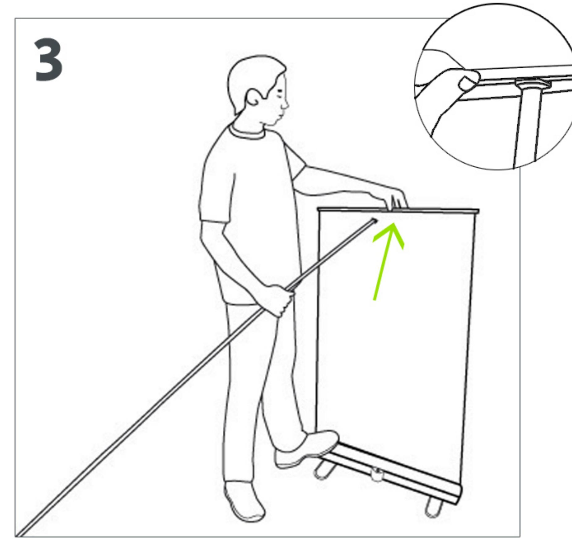
**Insérez la tête du mât dans la suspente.**
