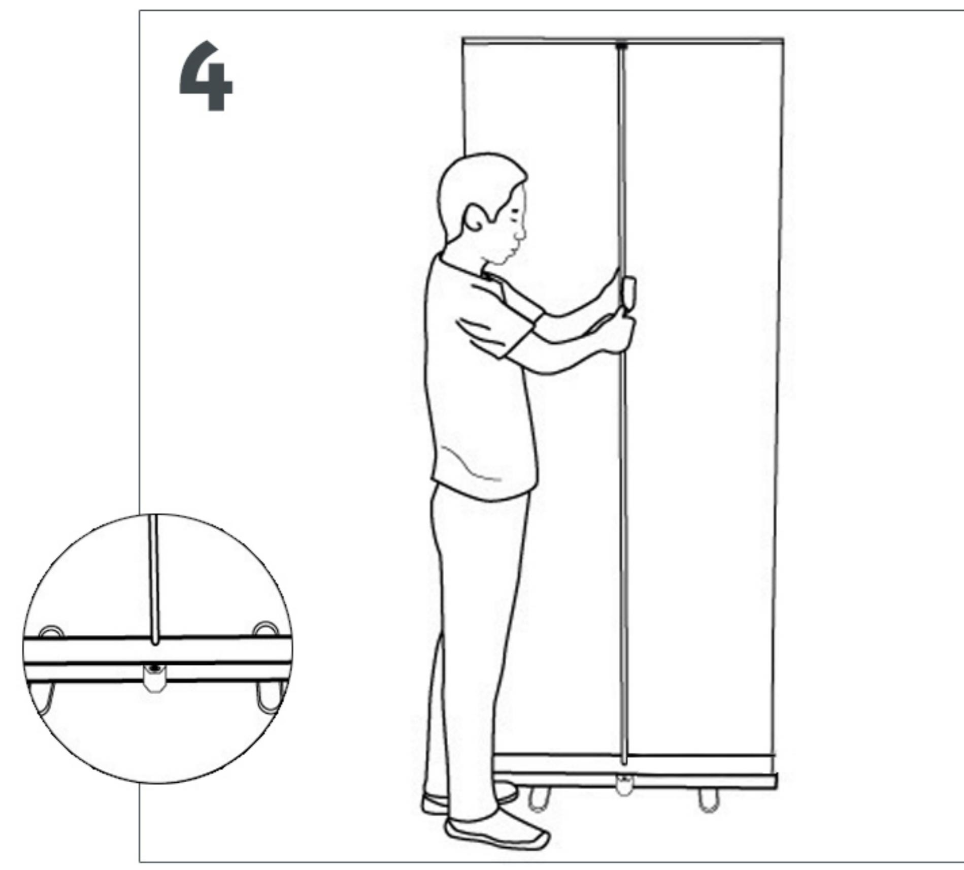
Positionnez le mât télescopique sur la base, puis ajustez la perpendicularité du visuel pour éviter les effets de vagues.
