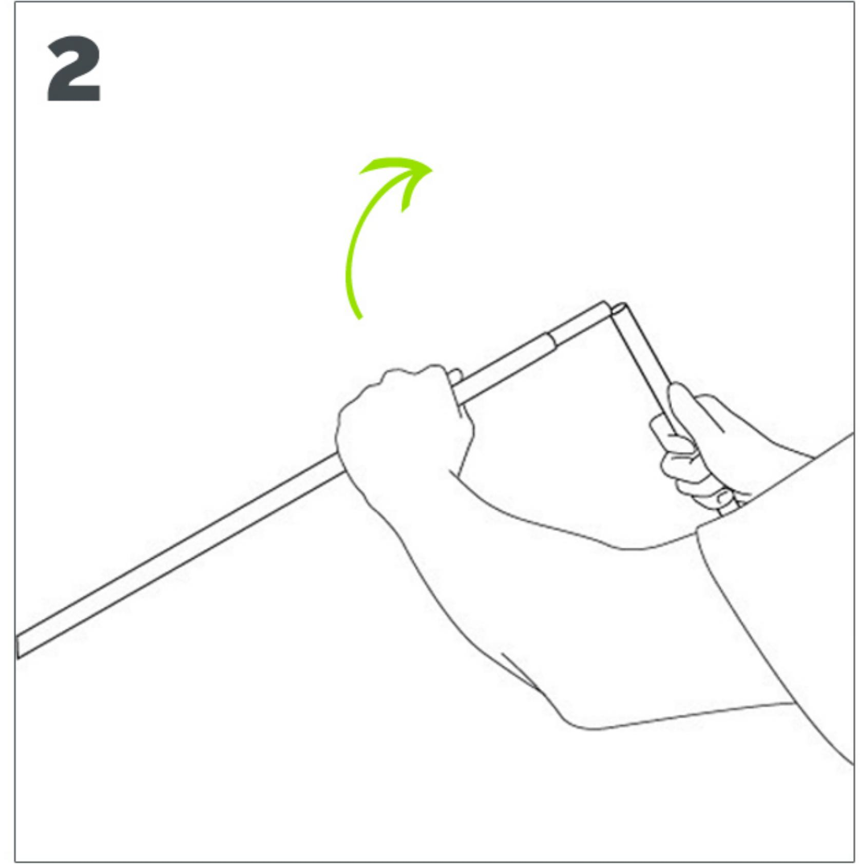
Déployez le mât en 3 parties. La tension des élastiques permet d'ajuster automatiquement les différents éléments.
