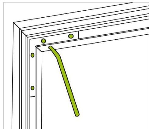
Terminer le montage d'un coté du cadre en fixant les 2 équerres.
