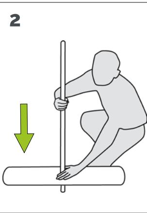
Positionner le mât télescopique sur la base.
