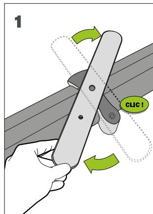
Faire pivoter le pied escamotable perpendiculairement à l'enrouleur, jusqu'au clic.
